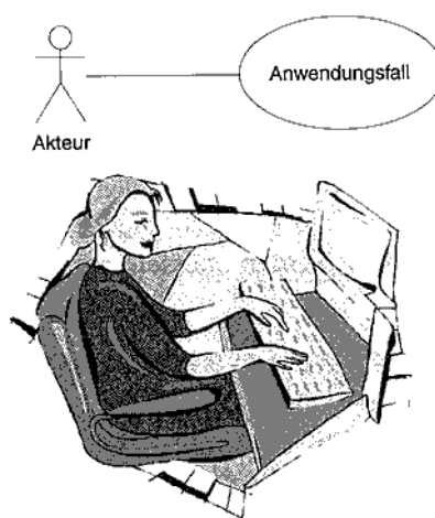
Abbildung 18 Akteur, „der“ einen Anwendungsfall ausführt
